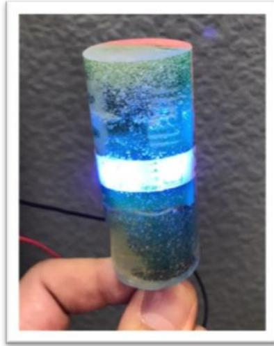
Рис. 2. Пример готового устройства – управляемый с ПК подводный LED-светильник
