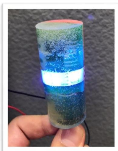
Рис. 4. Пример готового устройства – управляемый с ПК подводный LED-светильник.
